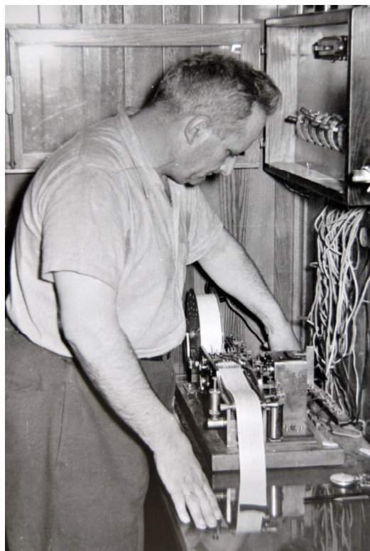
Слика 8: Контрола рада хронографа са пет пера.
