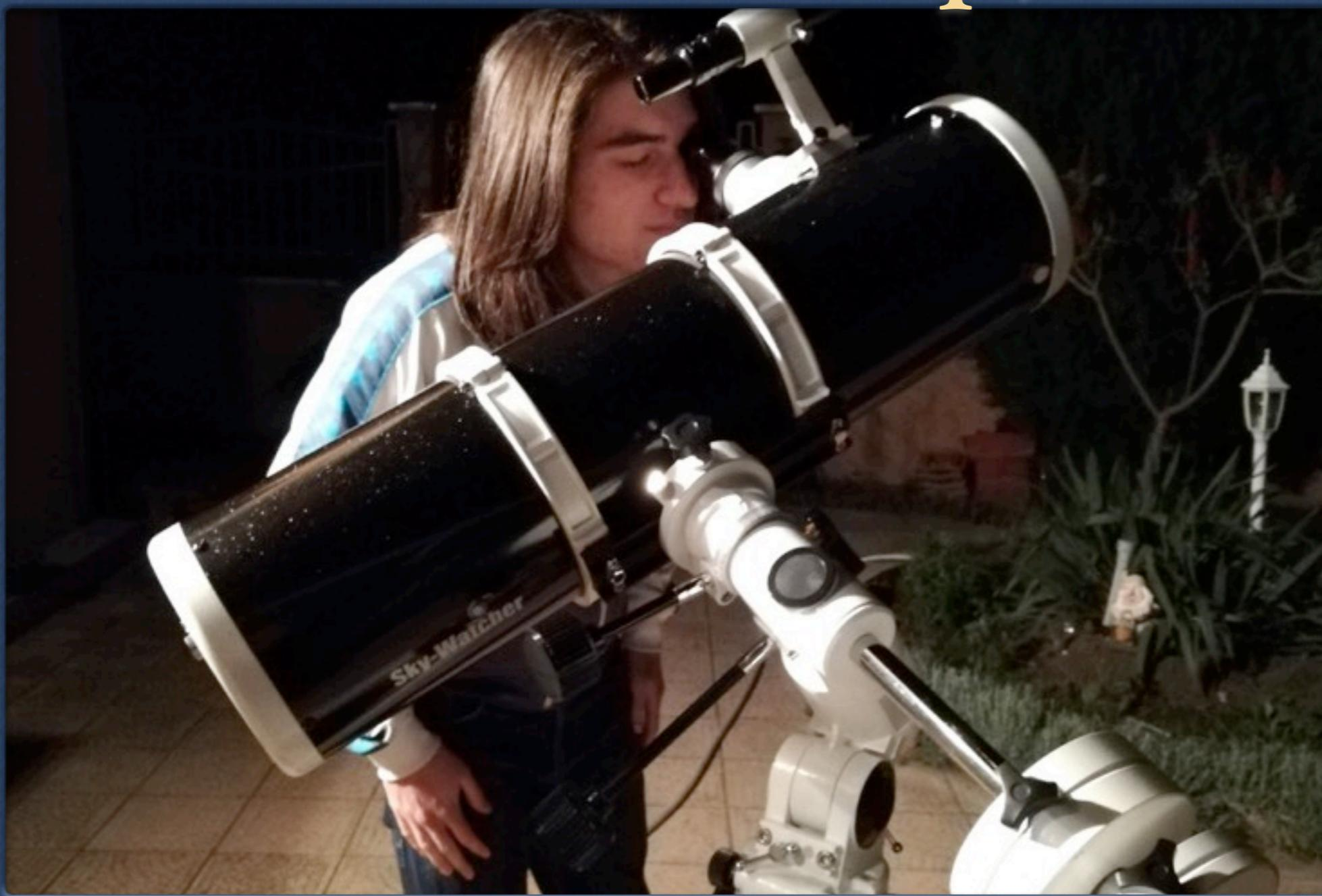
*Teleskop Njutnovog tipa, 150/750 sa ekvatorijskom montažom EQ3
